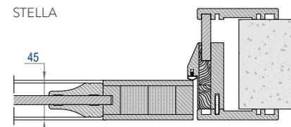
Традиционное исполнение, толщина полотна 45 мм,
