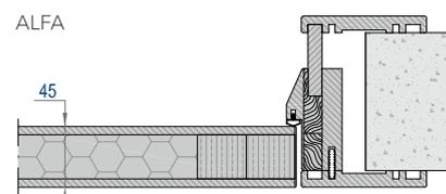
Традиционное исполнение, толщина полотна 45 мм,
