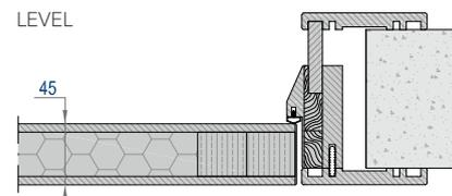
Традиционное исполнение, толщина полотна 45 мм,
