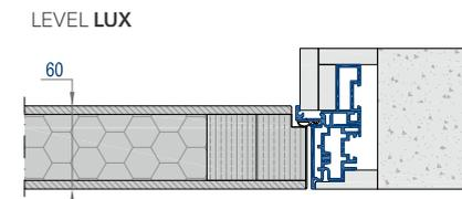
Толщина полотна 60 мм,
